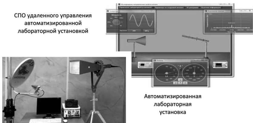
Рис. 3. Автоматизированный лабораторный макет для исследования направленных свойств антенн
